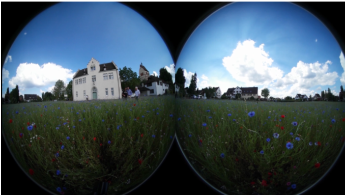
Ungestitchtes Videobild der zwei 180°-Fischaugen-Objektive einer 360°-Kamera
